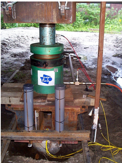
Automatische statische Probelastung (ASLT)
