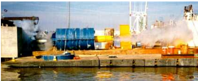
Querbelastungsprobe mit Statnamic in den USA
